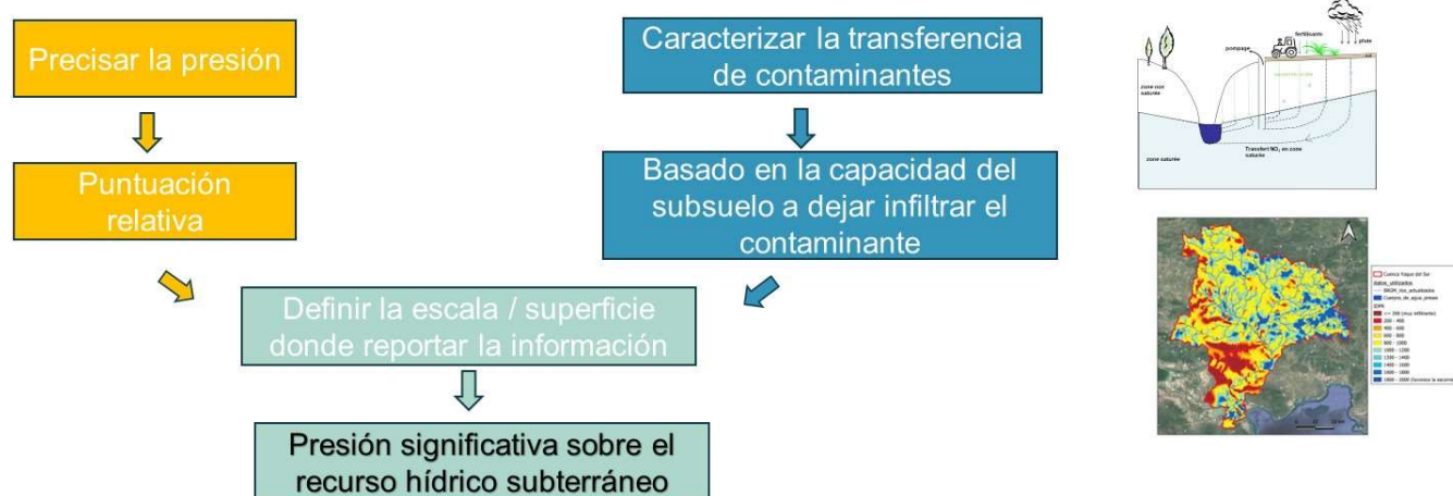
Ilustración 13: Esquema de la metodología aplicada para evaluar la presión significativa sobre el recurso hídrico subterráneo
